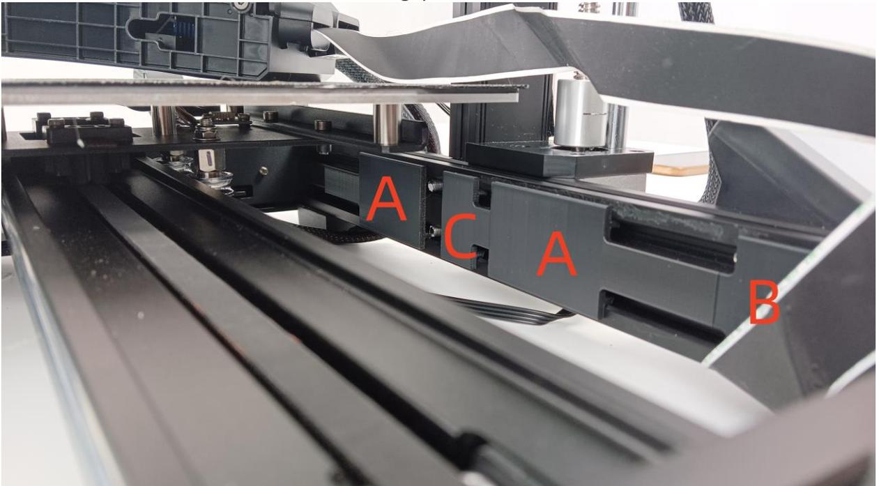
5. Stecken Sie das Flachbandkabel in den Befestigungsclip und montieren Sie den Befestigungsclip am Profil
