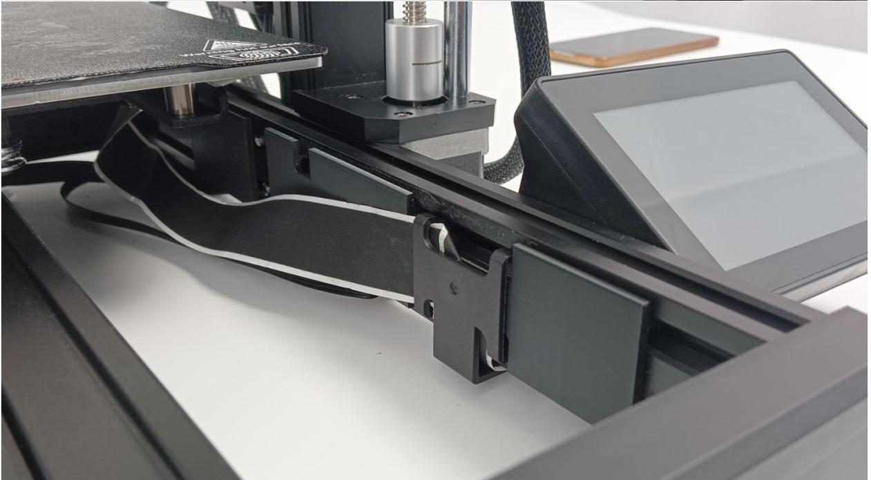
6. Überprüfen Sie nach Abschluss der Installation die Position des Bildschirmflachkabels, um zu verhindern, dass das heiÙe Bett beim Bewegen mit dem Bildschirmkabel kollidiert.
