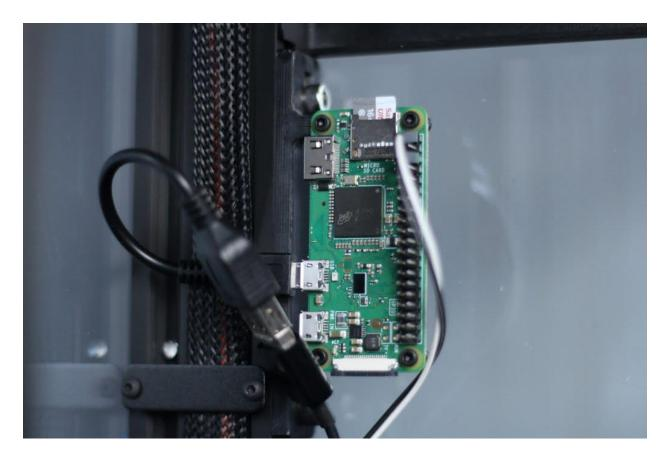
Falls Sie einen Raspberry Pi 3 oder 4 verwenden, benötigen Sie das OTG-Kabel nicht.
