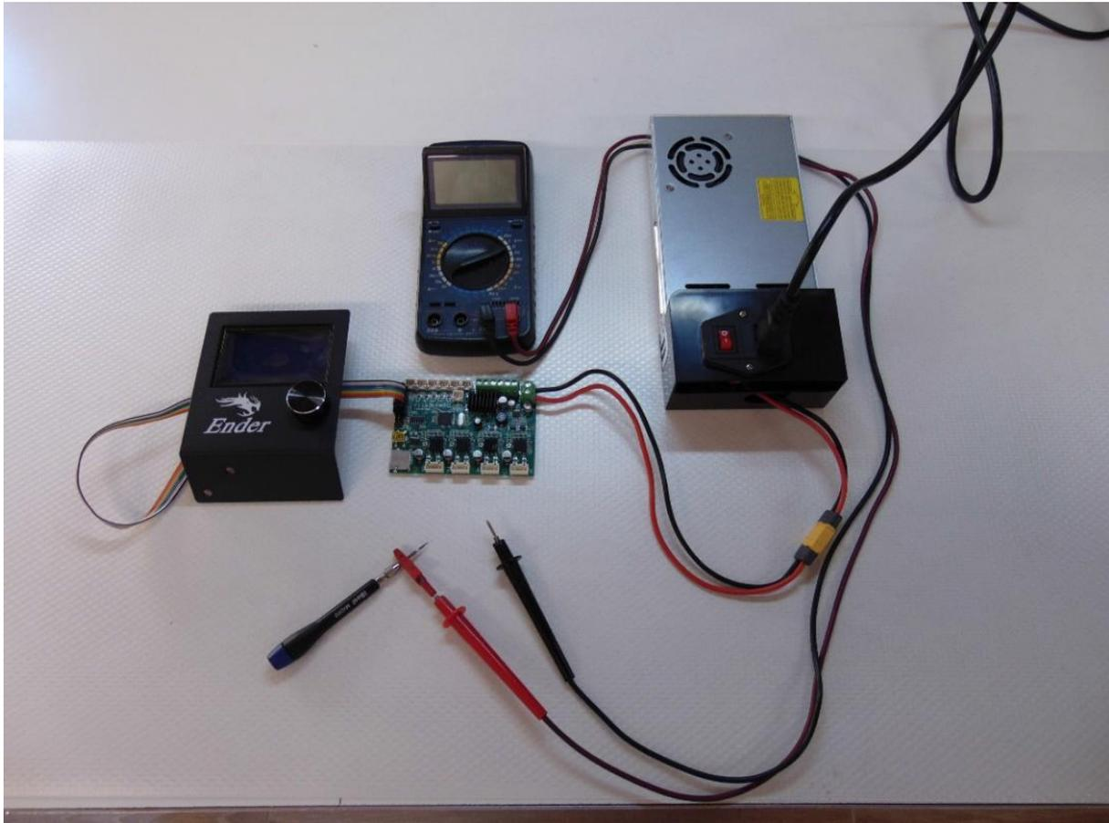
Wählen Sie auf dem Multimeter eine Spannung von 20 Volt DC full scale (oder einen Wert in der Nähe davon, wenn das Multimeter von dem hier verwendeten abweicht).
