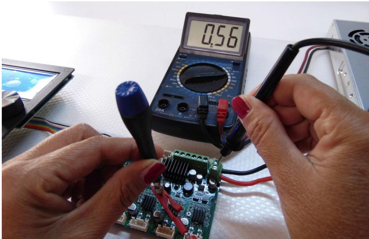
Das Bild dient nur als Referenz. ACHTUNG der Drehwiderstand muss der der Z-Achse sein.
