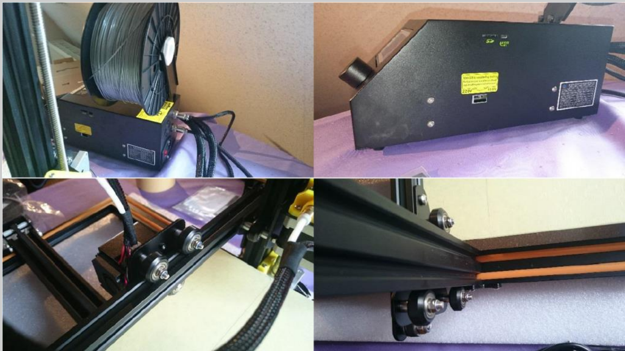
Steuerkasten & POM Rollen statt LMU8 Linearlager
